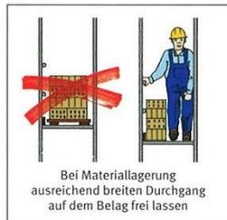
Bei Materiallagerung ausreichend breiten Durchgang auf dem Belag frei lassen
